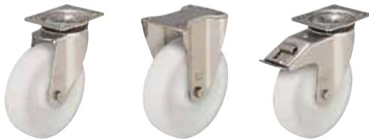
**Gehäuse:** Serie LKX/BKX - Aus hochwertigem , starkem , rostfreiem Chromnickelstahl (Werkstoff-Nr. 1.4301/AISI 304) gepresst , Lenkgehäuse mit zweifacher Kugellagerung im Drehkranz , mit stabilem Mittelbolzen (Rad-Ø 125x50 - 200 mm) , mit Drehkranzabdichtung . Die spezielle dynamische Vernietung des Drehkranzes bewirkt ein minimales Drehkranzspiel bei leichtgängigem Lauf und eine hohe Lebensdauer durch die Kaltverfestigung der Kugellaufbahnen .
