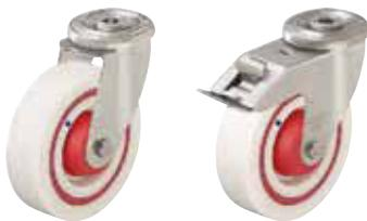
**Gehäuse:** Serie LEXR - Aus hochwertigem, rostfreiem Chromnickelstahl (Werkstoff-Nr. 1.4301/AISI 304) gepresst, mit zweifacher Kugellagerung im Drehkranz, mit stabilem Mittelbolzen, Kugelschutz durch besondere Formgebung der Bodenplatte und Kugelscheibe. Die spezielle dynamische Vernietung des Drehkranzes bewirkt ein minimales Drehkranzspiel bei leichtgängigem Lauf und eine hohe Lebensdauer durch die Kaltverfestigung der Kugellaufbahnen.
