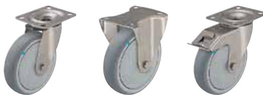
**Gehäuse:** Serie LEX/BX - Aus hochwertigem, rostfreiem Chromnickelstahl (Werkstoff-Nr. 1.4301/AISI 304) gepresst, Lenkgehäuse mit zweifacher Kugellagerung im Drehkranz mit Drehkranzabdichtung. Die spezielle dynamische Vernietung des Drehkranges bewirkt ein minimales Drehkranzspiel bei leichtgängigem Lauf und eine hohe Lebensdauer durch die Kaltverfestigung der Kugellaufbahnen. Sämtliche Einzelteile inkl. Achsmaterial sind rostbeständig. Radachse verschraubt. Oberfläche gleitgeschliffen.
